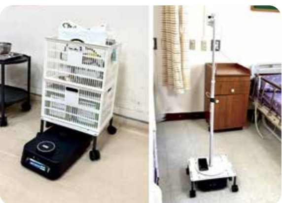
機器人(底下黑色機器)能將其上白色塑膠籃內的物資運送至護理站(左圖)；也能化身為「守夜人」，依路線自主巡邏，並透過架上的零接觸式感測器，監測住民的生理資訊和離床狀況(右圖)。(圖/板橋榮家)
