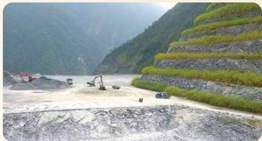
和仁礦區在採掘時，鄰近土地及已完成採礦的區域，亦同步展開排水改善與植生工程，減少環境衝擊。(圖／欣欣水泥)
